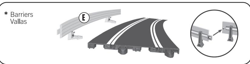
**Assembly Montage · Montaje · Montagem · Aufbau · Montage · Montaggio · Монтаж**
